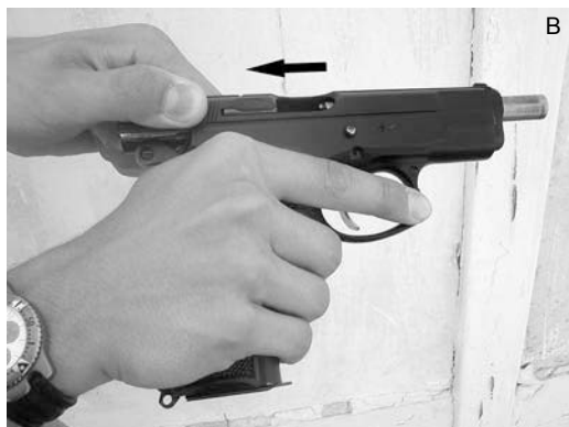
Obrázek 32 Univerzálním řešením situace, kdy nedojde k očekávanému výstřelu, je okamžité doražení zásobníku (a). Následuje natažení závěru (b). Tím se odstraní většina důvodů nefunkčnosti zbraně.
